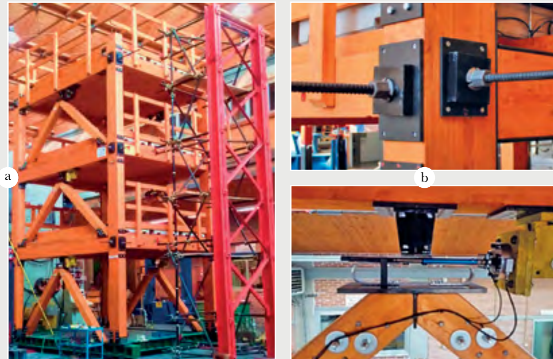
Figura 10. a) Modello sperimentale a telaio in legno lamellare con post-tensione e con controventi dissipativi testato presso il Laboratorio prove materiali e strutture UNIBAS; b) dettagli costruttivi del nodo trave colonna e dei controventi dissipativi.
